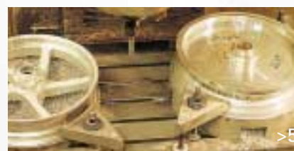
UNTERSCHIED ZWISCHEN EINER FELGE, DIE AUCH GEFRÄST WURDE UND EINER NUR GEDREHTEN FELGE
