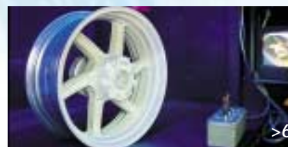
KONTROLLE MIT KRIECHFLÜSSIGKEITEN
